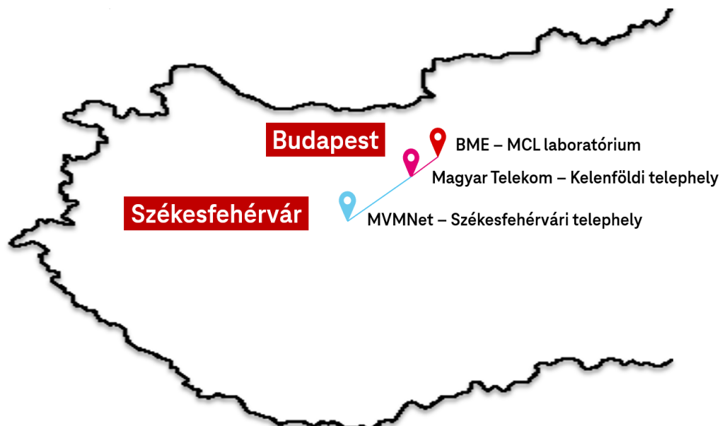
1. ábra: A megvalósított hálózat 3 csomópontból és 2 szakaszból áll. A 3 csomópont az MVMNet székesfehérvári telephelyén, a Magyar Telekom Kelenföldi telephelyén, valamint Budapesti Műszaki és Gazdaságtudományi Egyetem Mobil Kommunikációs és Kvantumtechnológiák Laboratóriumában (BME I épület) található. A két szakasz hossza Székesfehérvár és Kelenföld között 76 km, Kelenföld és az egyetem között 2,5 km
